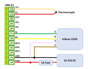
Figure 3 - Iridium Edge Wiring Diagram
